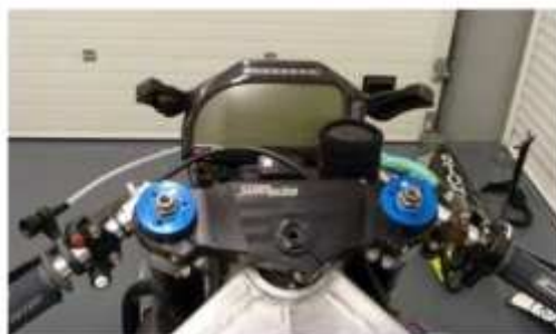
La fourche Krypton montée sur le cadre Suter - 16/12/2010
